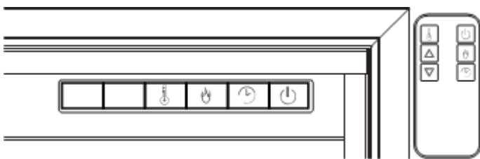
Примечание. Элемент сохраняет тепло после выключения. Существует встроенный период охлаждения 30 секунд, прежде чем вентилятор полностью отключится.
