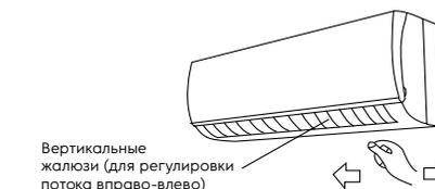
Направление воздушного потока в горизонтальной плоскости изменяется вручную поворотом вертикальных жалюзи.
