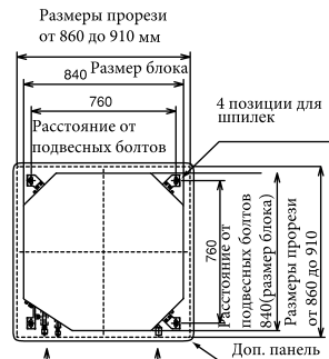
Страна подсоединения труб Подсоединение дренажной трубы Подготовка места установки блока в подвесном потолке
