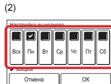
По завершении установки коснитесь кнопки [OK]. После того, как будет отображен экран завершения установки, дисплей вернется к экрану «Наст. недельного таймера».
