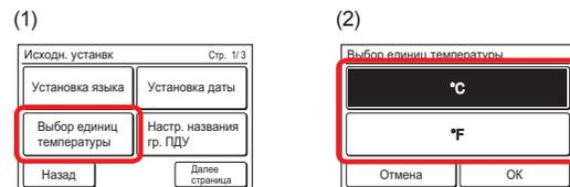
После нажатия [OK] и отображения экрана изменения установки дисплей вернется к экрану «Исходн. устанвк».
