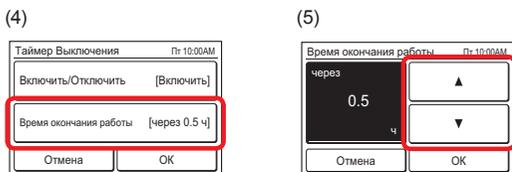
При касании [OK] дисплей вернется к экрану «Таймер Выключения».
