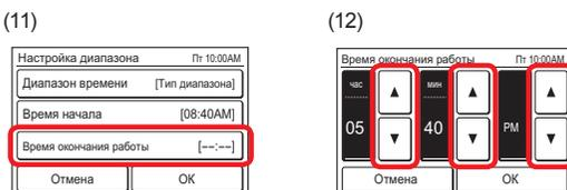
При касании [OK] дисплей вернется к экрану «Настройка диапазона».
