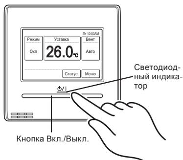
Светодиодная лампа продолжает гореть при работе внутреннего блока.
