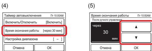
При касании [OK] дисплей вернется к экрану «Таймер автовыключения».
