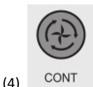
В режиме непрерывной работы дисплей осушителя отображает текущее значение уровня влажности, горит индикатор непрерывной работы.
