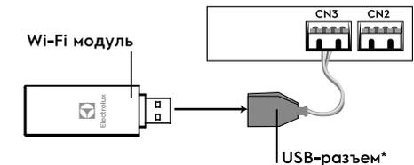
\* Разъем для подключения Wi-Fi модуля
