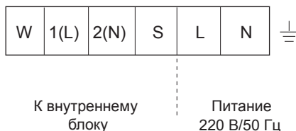
Клеммы для подключения проводов на наружном блоке
