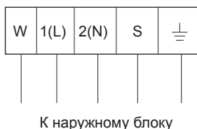
Клеммы для подключения проводов на внутреннем блоке
