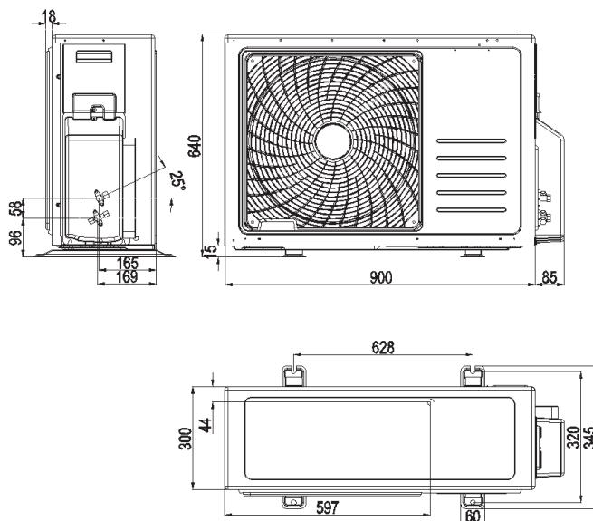
На рисунке ниже указаны габаритные и установочные размеры наружного блока KC III-36/O.
