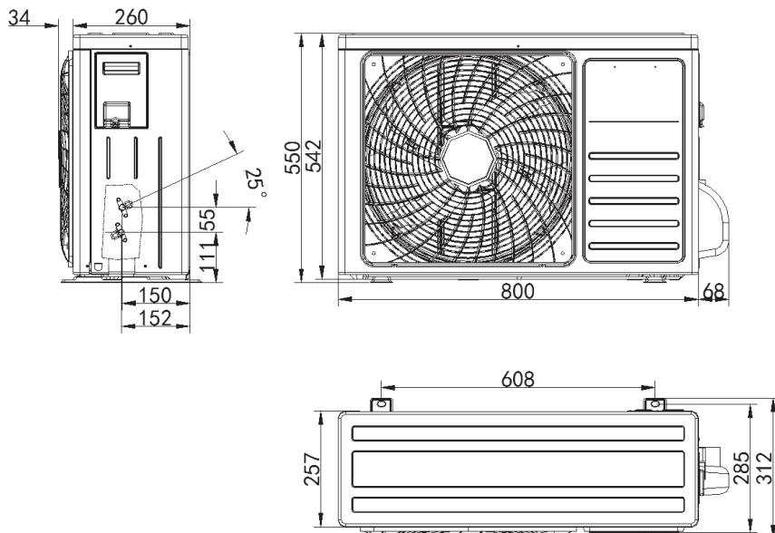
На рисунке ниже указаны габаритные и установочные размеры наружного блока KC III-24/O.
