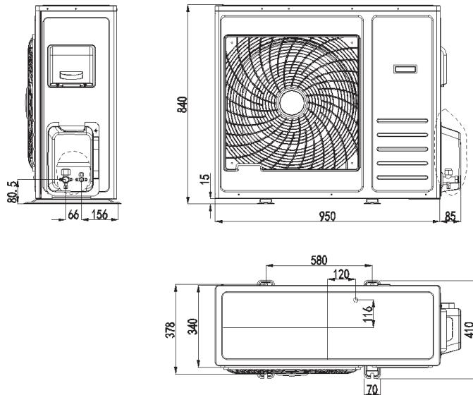
На рисунке ниже указаны габаритные и установочные размеры наружного блока KC III-48/O.
