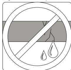
Проверьте отсутствие течей
