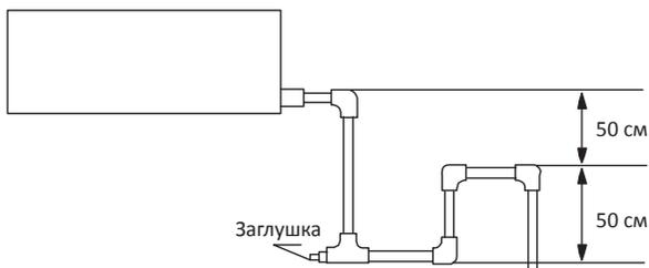
Допускается подсоединять несколько внутренних блоков к общей дренажной трубе (см.рис). Внутренние блоки с дренажной помпой и внутренние блоки без нее следует подключать к разным системам отвода конденсата.
