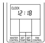
**2** Нажмите кнопку ОСНОВНОГО КОНТРОЛЯ (рис. 4 ⑪) и удерживайте ее в течение более 5 секунд, чтобы вывести на дисплей текущий код сигналов (изначально установленный на А).
