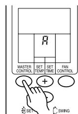
**3** Используйте кнопки + / - (см. рис. 4 ⑫) для изменения кода сигнала в последовательности А → В → С → D таким образом, чтобы код на дисплее пульта совпал с кодом сигналов для кондиционера воздуха.
